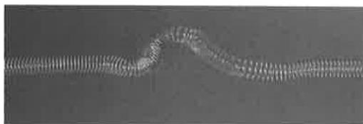
図5 鶴巻ばねの横波の実験
