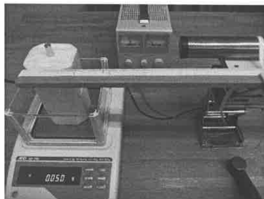
図3. 電子天秤による磁気力の測定
