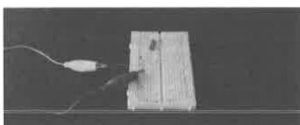
図 8 LED に交流電流を流す
