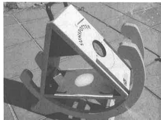
図 5 投影型太陽望遠鏡
