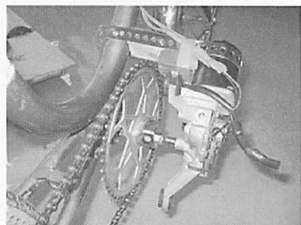
写真6 2輪班のモーター接続部分
