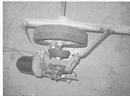
写真7 3輪班のモーター接続部分
